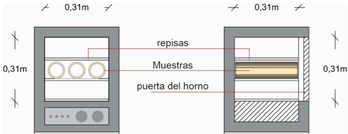
Figura 2. Disposición de las muestras dentro del horno
