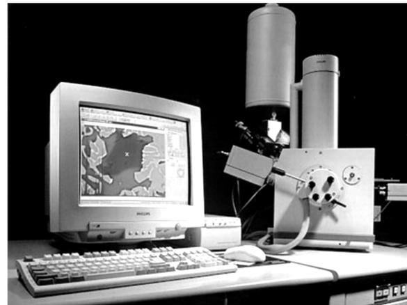
Figura 1. Microscopio electrónico de barrido
