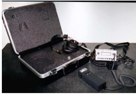
Figura 2. Equipo detector de varilla en concreto
