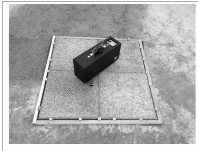
Figura 1. Generador de sonido de impacto ubicado
